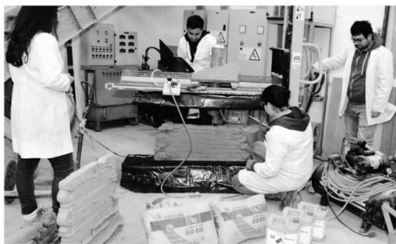
Fueron varios meses de experimentación para los jóvenes, pero la impresión 3D para obtener el muro solo tardó 20 minutos.
